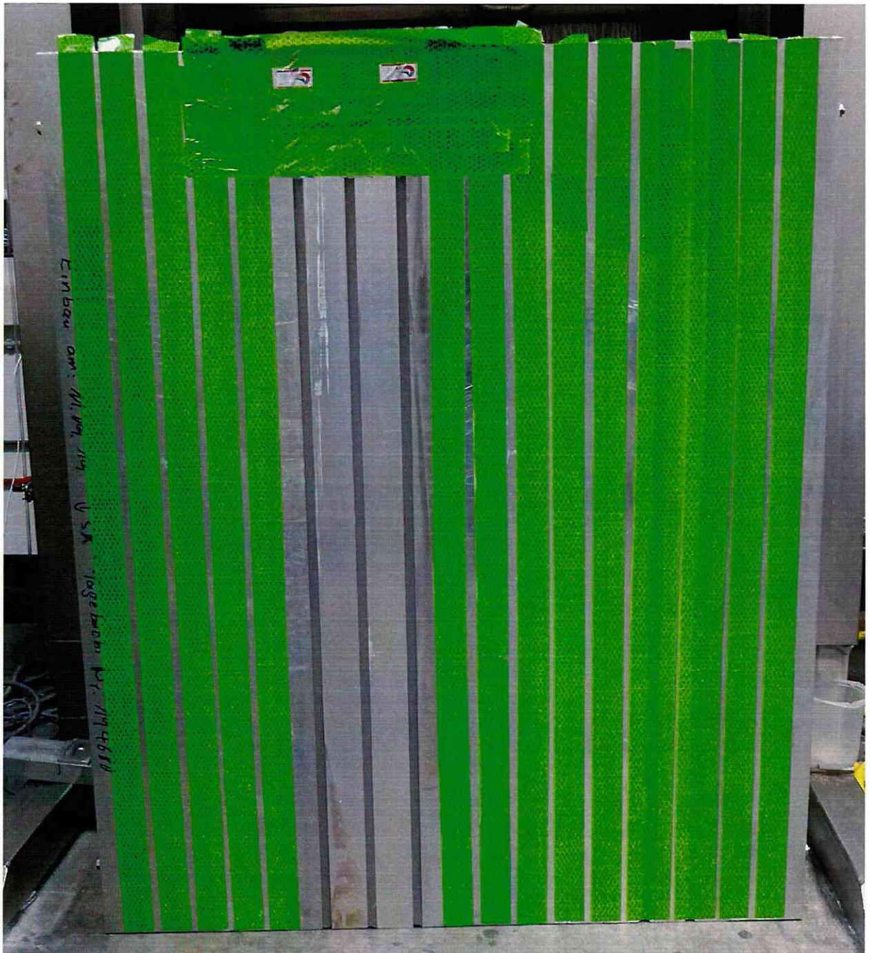
Bild 4: Versuchskörper mit den eingebauten Fugendichtungsbändern (Blick auf schlagregenbeaufschlagte Seite)
