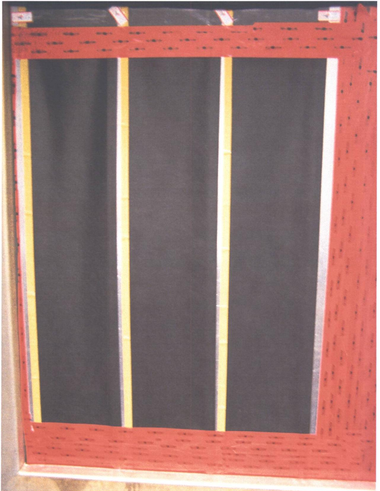
Bild 4: Versuchskörper (Seite, die der Luftdurchlässigkeits- und der Schlagregenprüfung ausgesetzt wird), bestehend aus Hohlkammerprofilen (Querschnitt 60 mm x 100 mm) mit dazwischenbefindlichen Fugen (Breite 200 mm), über die die zu prüfenden Fugendichtungsfolien angebracht wurden. Größe des Versuchskörpers (rd.): Höhe 1,38 m x Breite 1,07 m.
