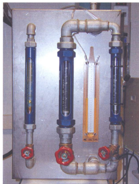
Bild 3b: Prüfstand-Steuerung (Wasser- u. Luftmenge)
